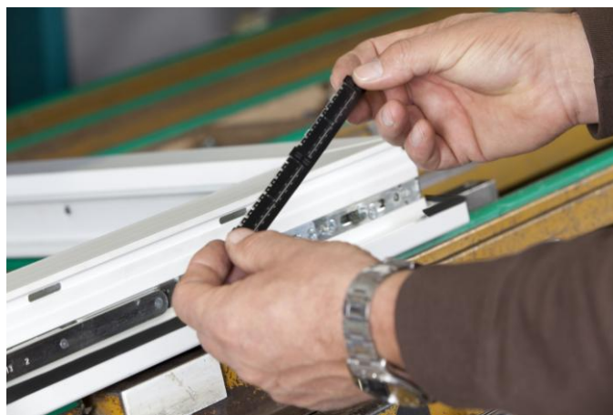
Der neue beschlagsunabhängige Fensterfalzlüfter arimeo mit neuartiger Fließgelenktechnik ist komplett ift-geprüft.
