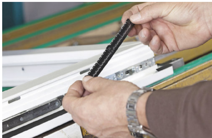
Beschlagsunabhängiger Fensterfalzlüfter mit Fließgelenktechnik
