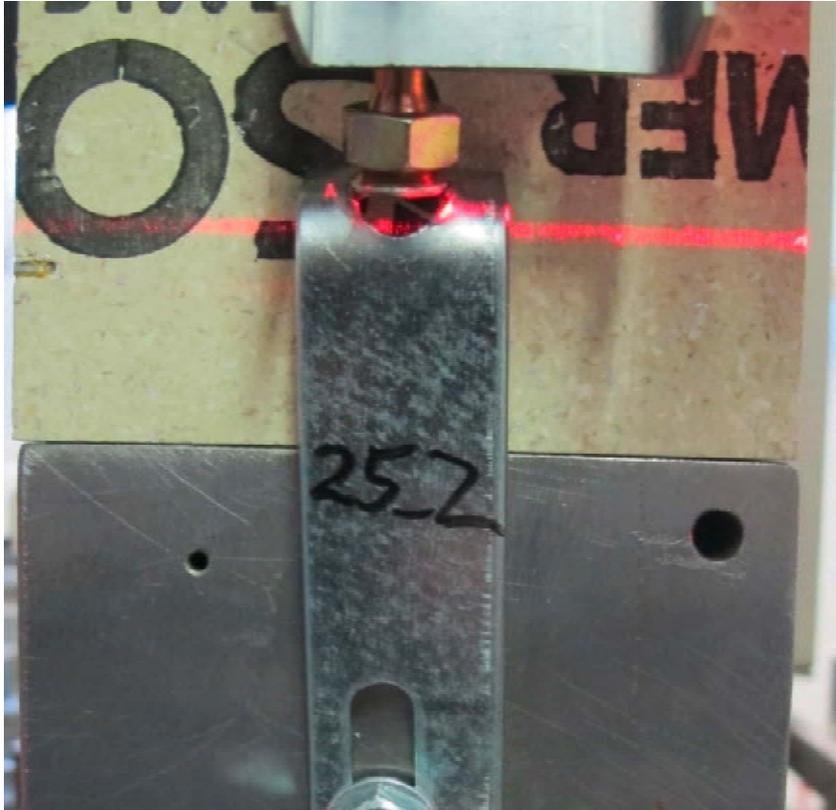
Abbildung 5-5 Anker 25-2 – Zustand nach Maximalkraft (5,74 kN)
