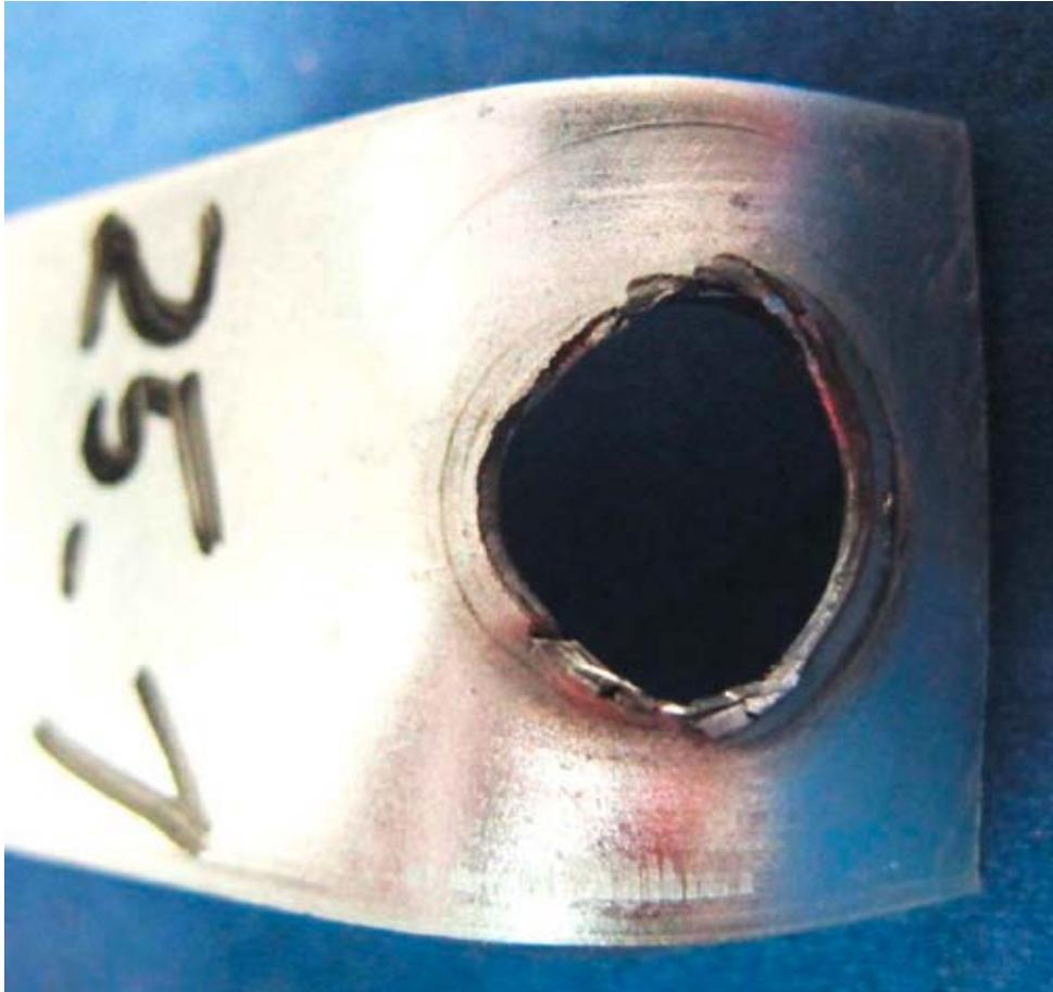
**Abbildung 5-7 Anker 25-1 – Blechversagen Schraubenanbindung**
