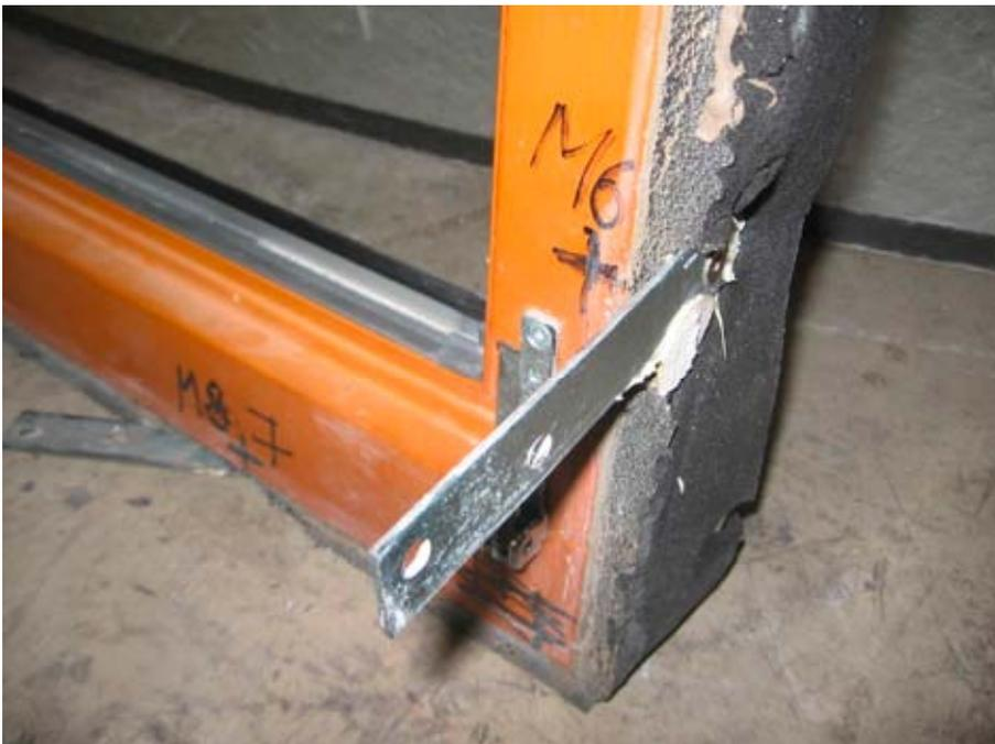
**Bild 2** Mechanische Befestigung und Lastabtragung mit Innoperform Justieranker „JUSTA“ nach Ausbau des Fensters am Ende der Prüffolge
