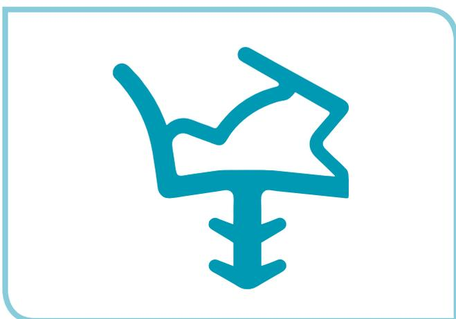
Querschnitt einer originalen Tüрдichtung (Quelle: Deventer)
