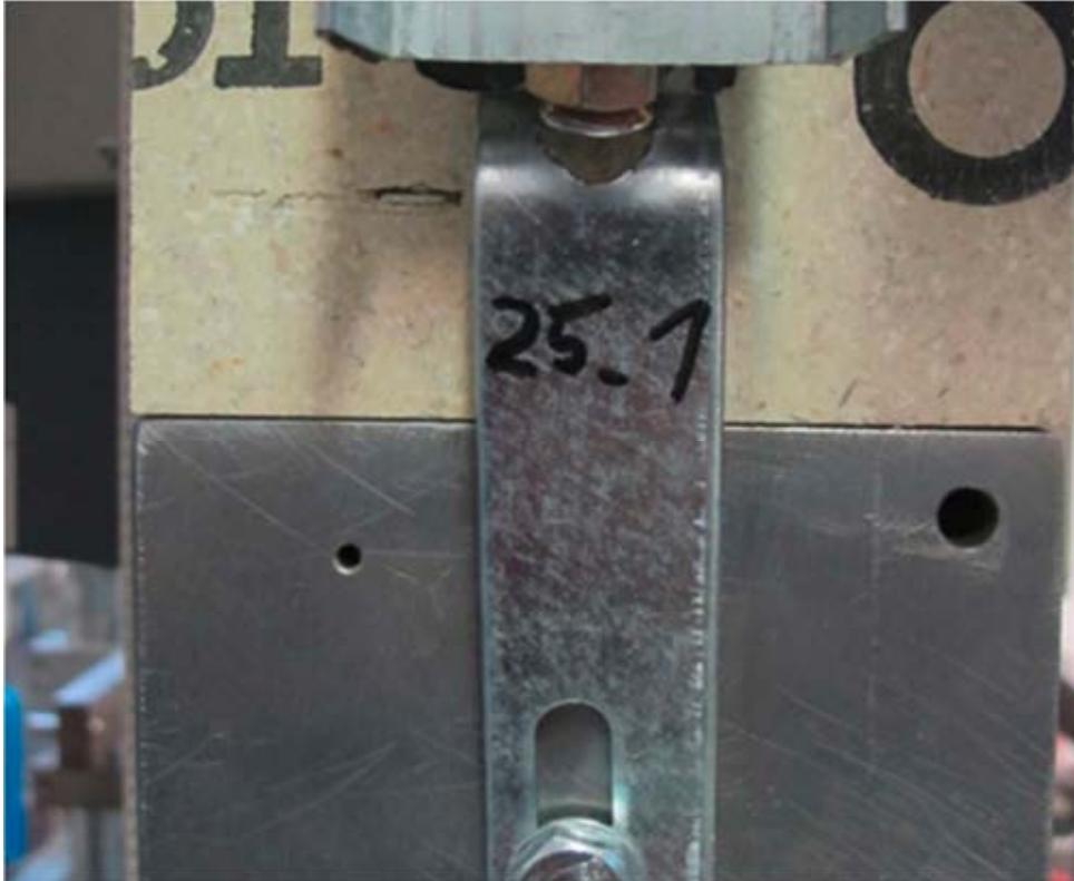
**Abbildung 5-3** Anker 25-1 - Zustand nach Maximalkraft (5,24 kN)
