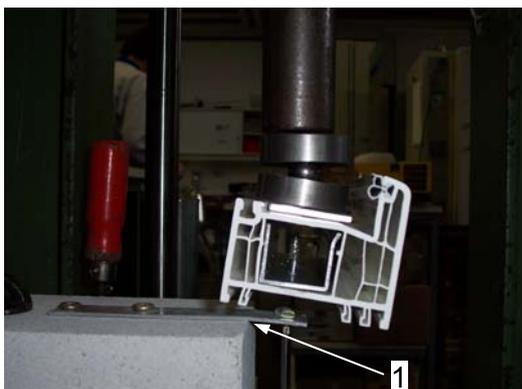
1 Ankerlasche bleibend verformt auf Höhe der Mauerkante
