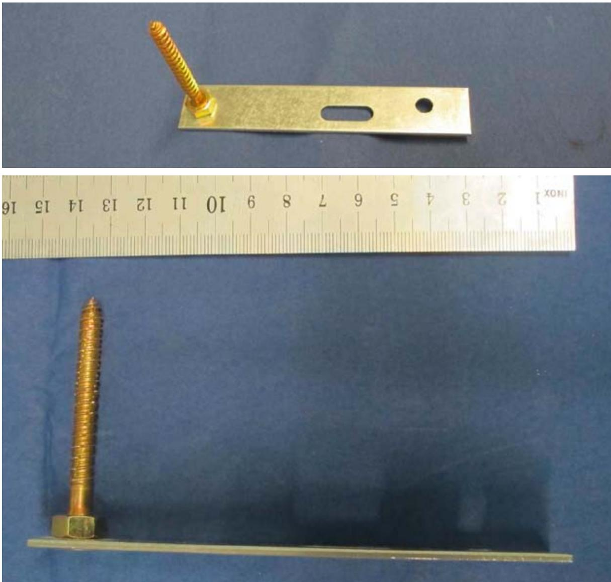
Abbildung 2-1 Befestigungsanker
