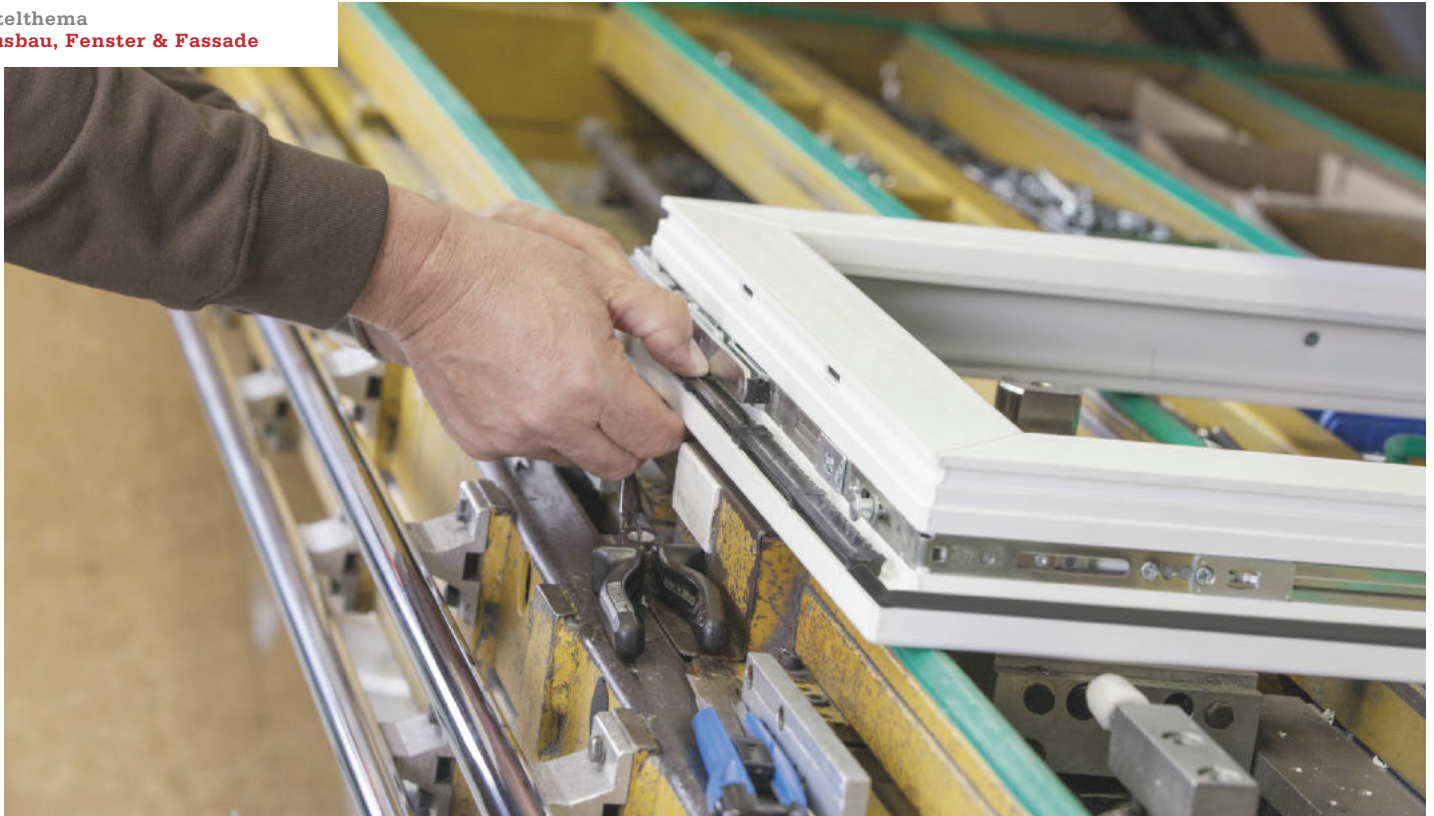
I Auf engstem Bauraum einfach eingesetzt: Der beschlagsunabhängige Fensterfalzlüfter für Anschlag- und Mitteldichtungssysteme wird einfach in der Nut der Flügeldichtung eingerastet und es muss dabei keine Rücksicht mehr auf Beschläge genommen werden.
