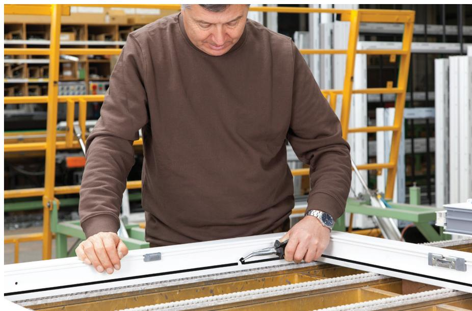
Austausch der Blendrahmendichtung.
