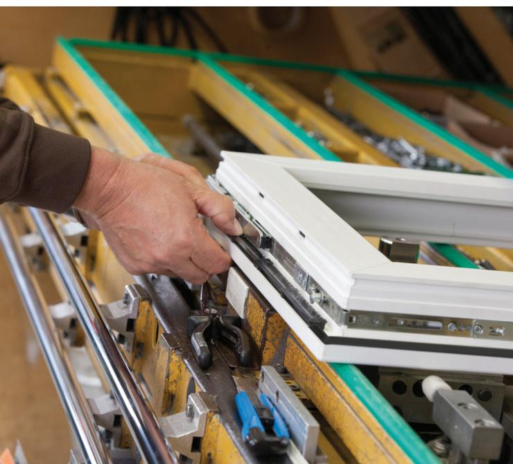
*Der neue Lüfter wird in der Nut der Flügeldichtung eingerastet, kann also unabhängig von der Position der Beschläge montiert werden.*
