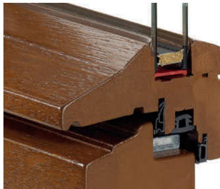
Bei Objekten, die besonderen Auflagen der Renovation unterliegen, kann die Fenster-Ausführung HistoricLine mit Kittfalzoptik (KF) eben diese ursprüngliche Verglasungsart nachempfinden. Der äußere Glasnackten verläuft etwa in dem Winkel, in dem früher der Kitt das Glas gehalten und abgedichtet hat.
