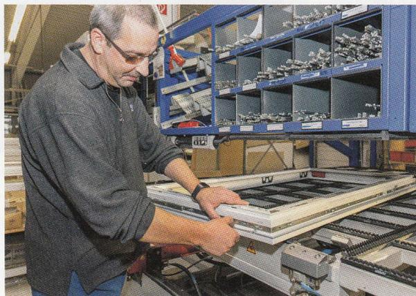
Der arimeo Fensterfalzlüfter wird im BBE-Werk montiert.
